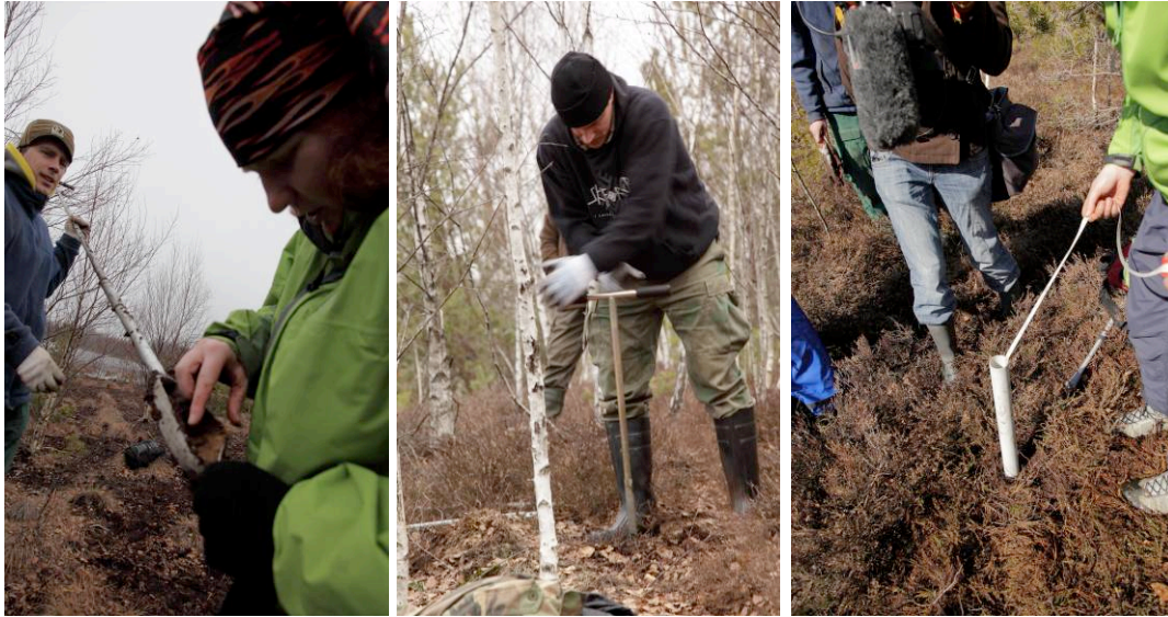
6. att. Urbumu ierīkošana un GŪL mērījumi, DL Melnā ezera purvs
